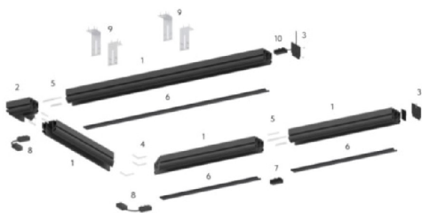
Схема сборки трековой системы SMART ONE
